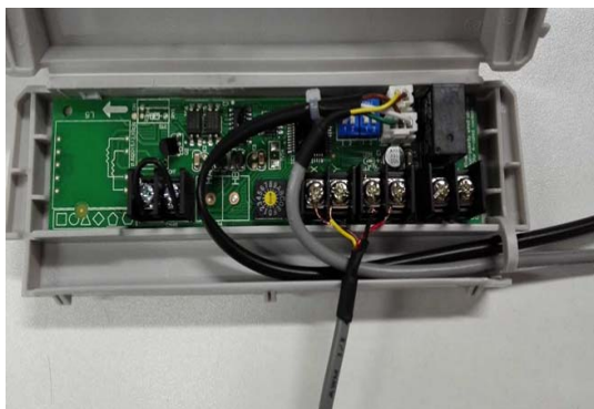
Fig. 26 – Branchement du câble à la carte
