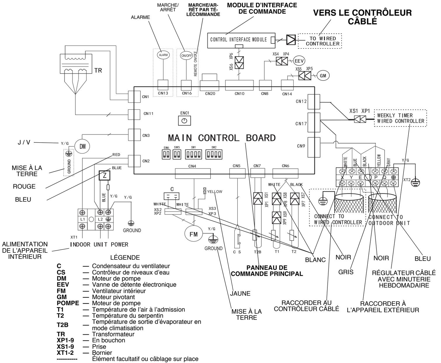
**Fig. 10 — Schéma du câblage type du 40WAC007-015**
