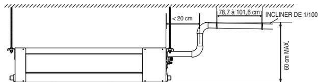
**Fig. 9 — Tuyauterie de condensat**
