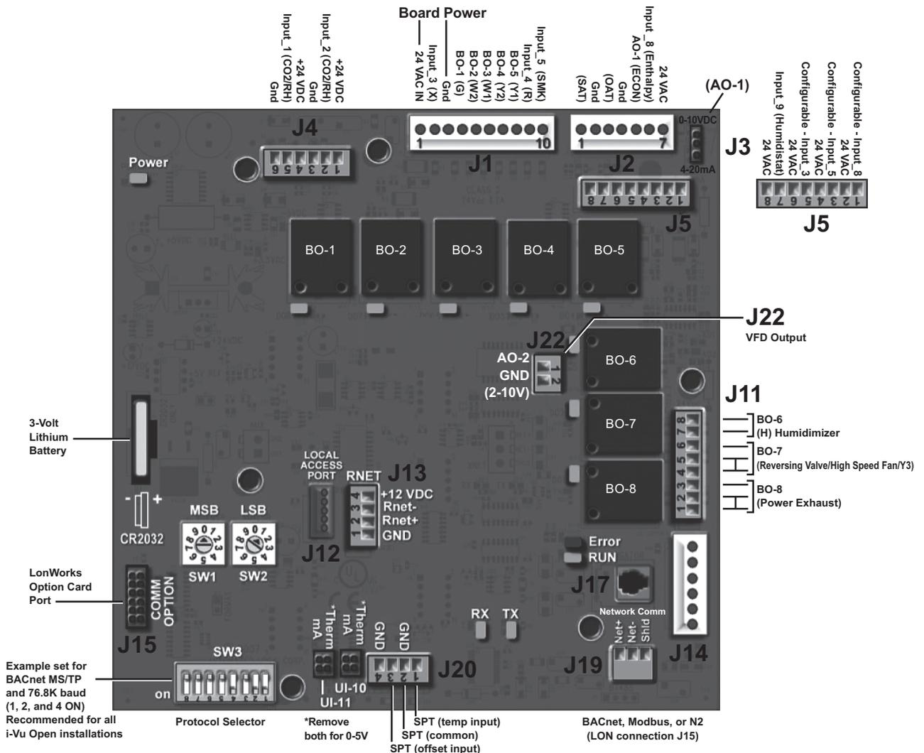
**Fig. 93 — RTU Open Multi-Protocol Control Board**
