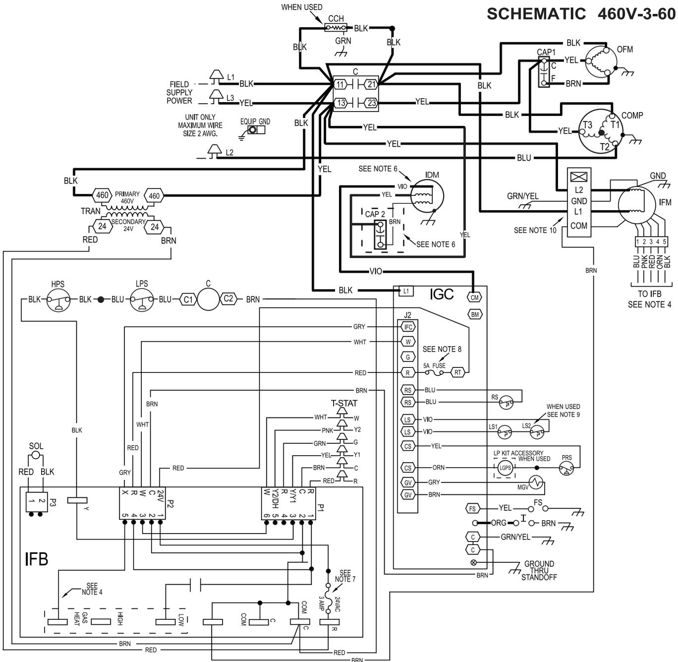
**Fig. 19 - 460-3-60 Connection Wiring Diagram**
