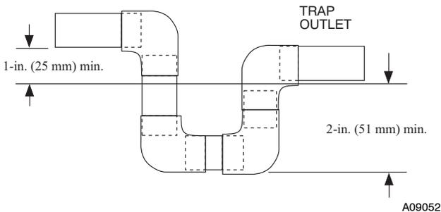
**Fig. 7 - Condensate Trap**
