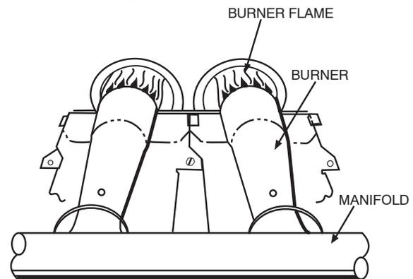
Fig. 12 - Monoport Burner
