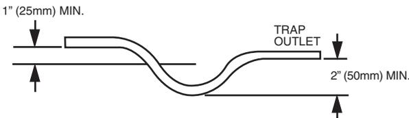
Fig. 12 - Condensate Trap
