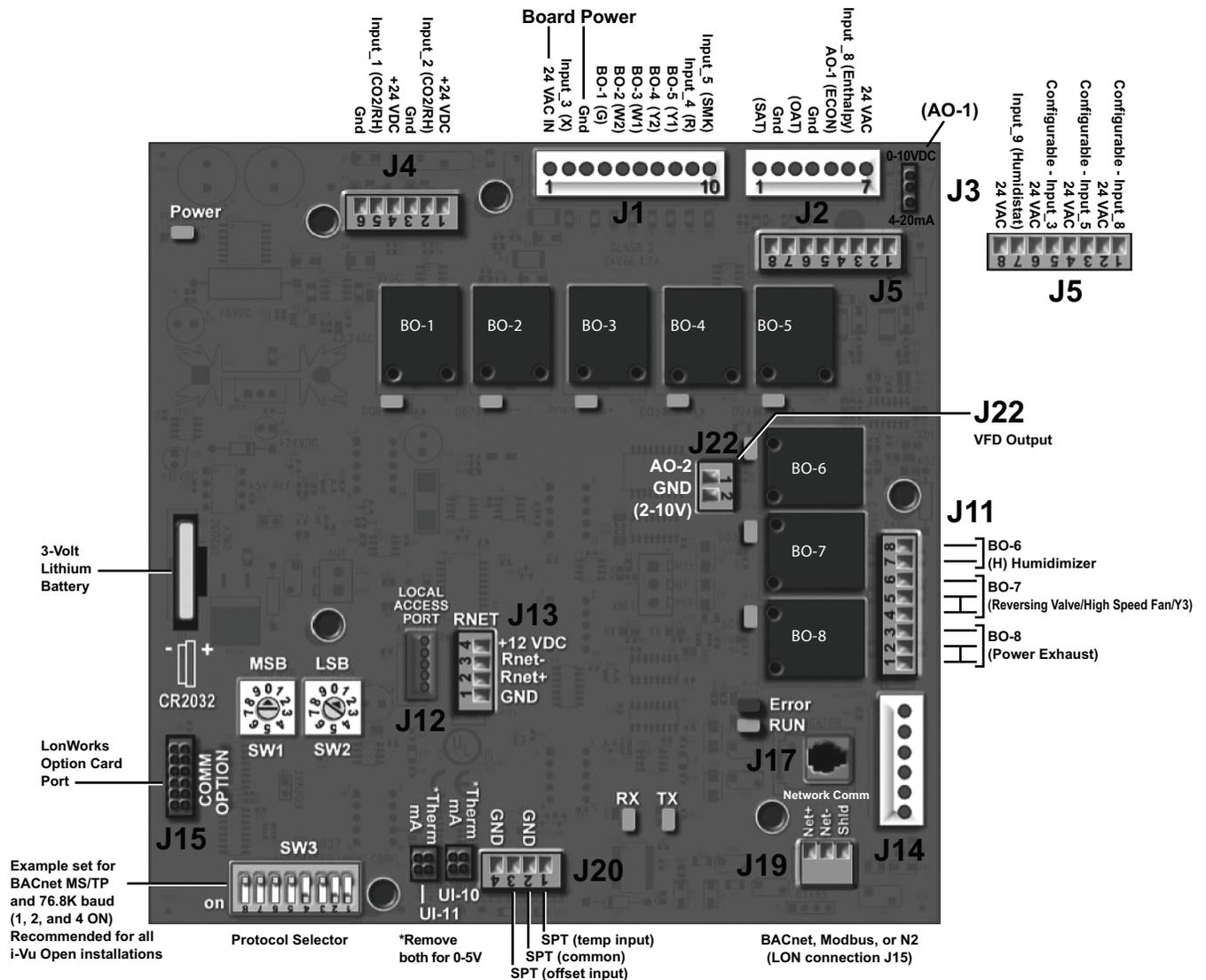
**Fig. 66 — RTU Open Multi-Protocol Controller Board**
