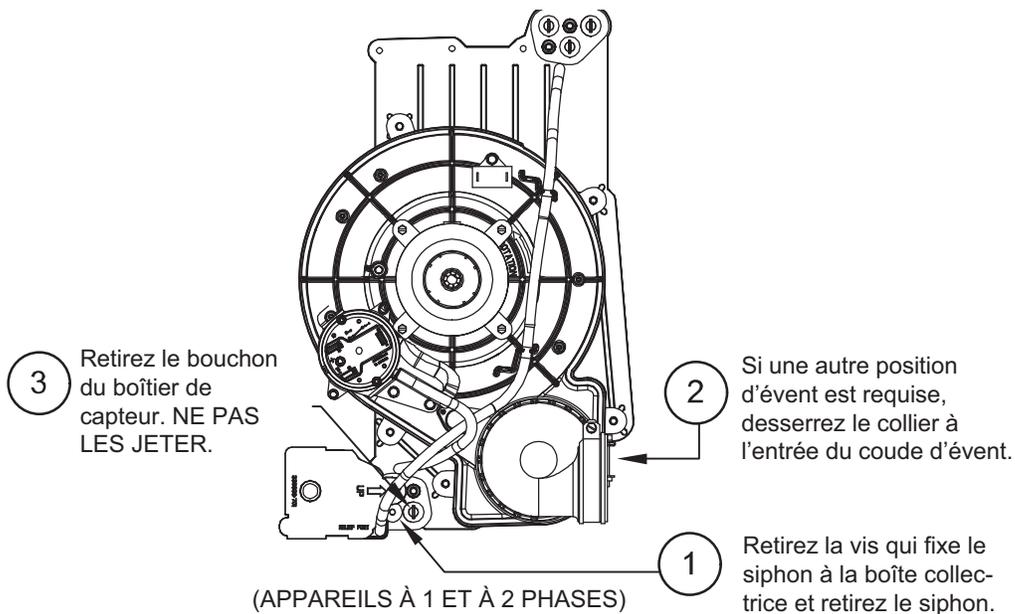
**Configuration non convertie en usine telle que vue en position horizontale à droite**
