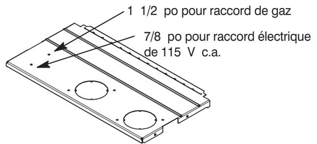
REMARQUE : La plaque supérieure peut être percée pour fournir une entrée facultative de gaz et d'électricité 115 V c.a.
