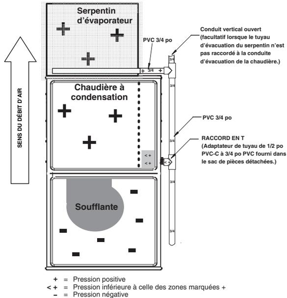
Fig. 14 – Exemple de fixation au drain
