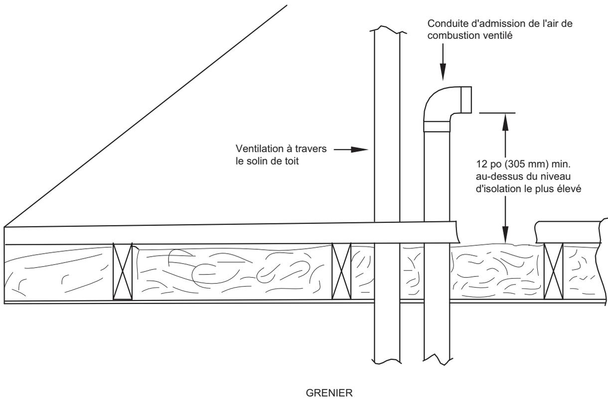
Fig. 55 – Sorties d'évent pour système à air de combustion ventilé
