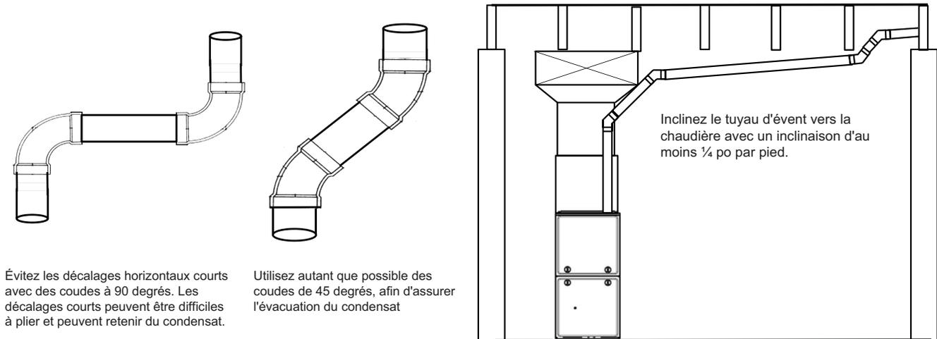
Fig. 41 – Raccordement des événements près de la chaudière
