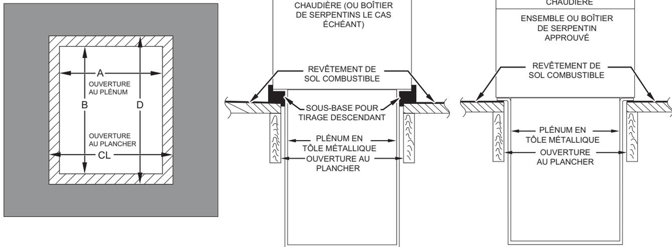
Fig. 20 – Installation sur revêtement de plancher combustible
