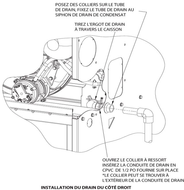
**Fig. 15 – Œillet d'évacuation de condensat formé en caoutchouc**
