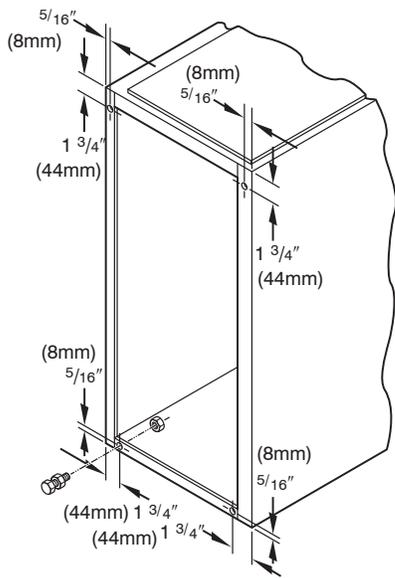
Fig. 24 – Pattes de mise à niveau
