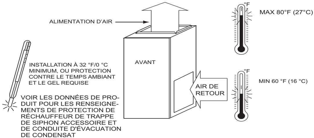
Fig. 3 – Protection contre le gel et température de l'air repris
