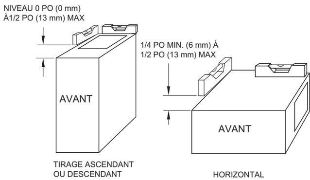
Fig. 25 – Exigences d'inclinaison de la chaudière
