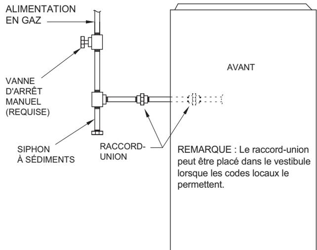
Fig. 33 – Disposition type de la tuyauterie de gaz
