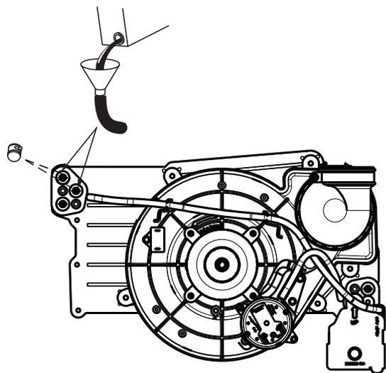
Fig. 64 – Amorçage du siphon de condensat
