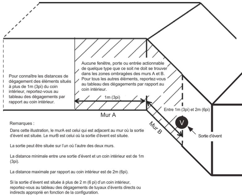
**Fig. 43 – Sorties dans les coins intérieurs**
