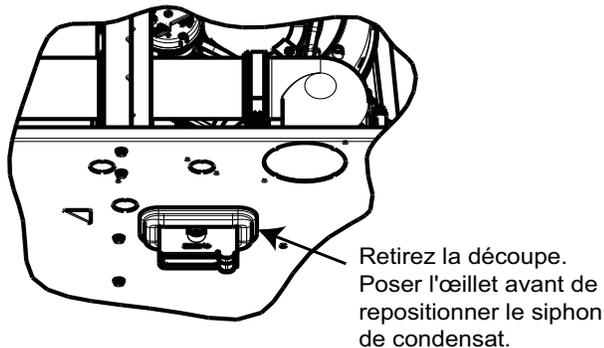
**Fig. 17 – Œillet de siphon d'évacuation horizontal**
