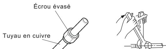
Figure 10 – Serrez l'écrou évasé.
