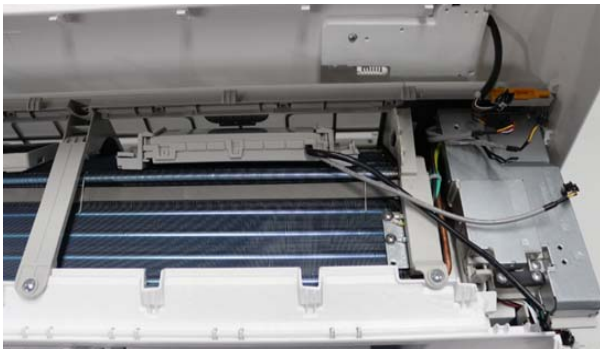
Figure 32 – Branchement de la carte multifonction
