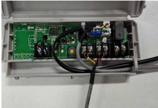
Figure 30 – Branchement du câble à la carte
