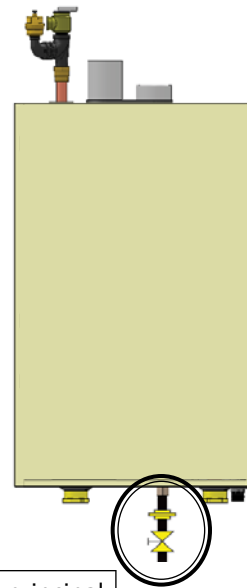
Robinet manuel principal d'alimentation en gaz
