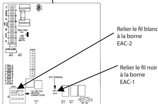
Figure 14 – Installation du cordon d'alimentation dans le panneau de commande de l'appareil de chauffage
