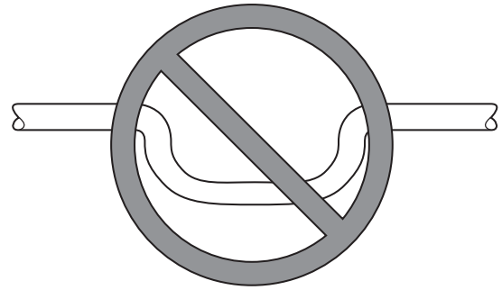
Afb. 13 - Ongeschikte afleider voor het condenswater
