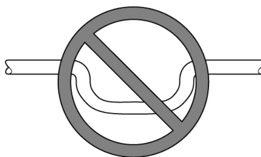
Εικ. 13 Ακατάλληλο σιφόνι συμπυκνωμάτων
