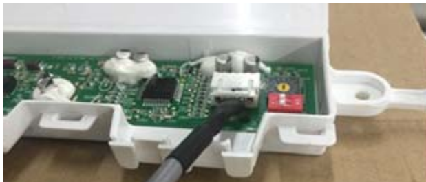
Figure 25 – Raccordement entre module adaptateur et panneau d'affichage
