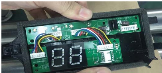
Figure 23 – Panneau d'affichage installé sur le support de panneau d'affichage
