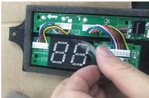
Figure 24 – Couvercle de panneau d'affichage
