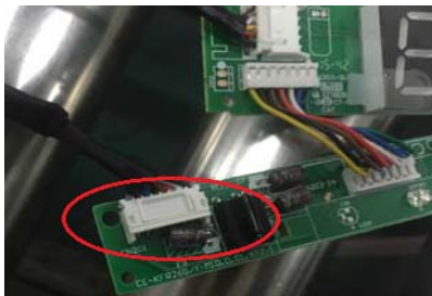
Figure 19 – CN201 est la connexion à la carte-mère principale
