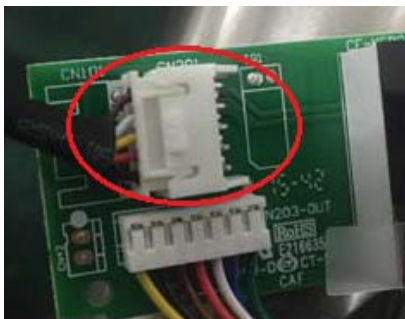
Figure 20 – CN101 est la connexion au module adaptateur
