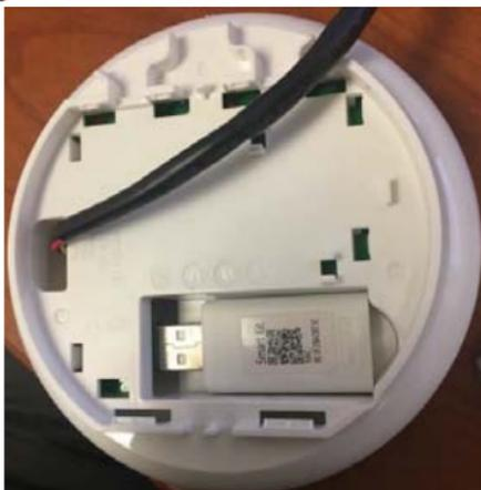
**Figure 5 – Insérer le dongle Wi-Fi dans le port USB**
