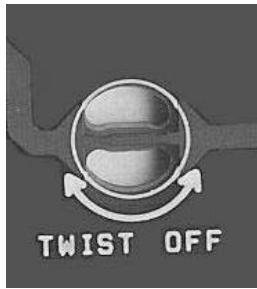
Fig. 1 - Cavalier interrupteur du circuit imprimé (Twist off = Dévisser)
