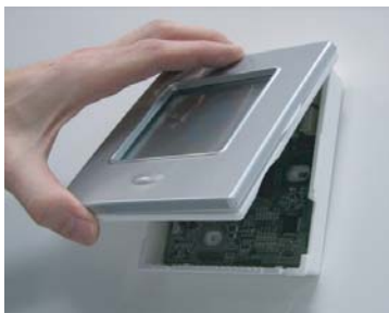
Fig. 15 - Remboîtez le module d'affichage
