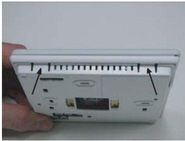
Fig. 4 - Appuyez sur les languettes pour retirer la plaque arrière
